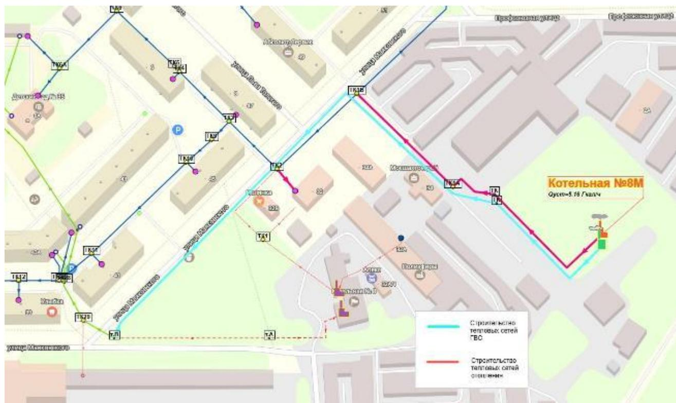
Рисунок 4.6 – Строительство участков тепловых сетей от котельной №8М
